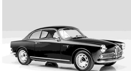
8.- Arriba, el Toyota C-HR de 2017, y abajo, el Alfa Romeo Sprint de 1954. Obsérvese la cantidad de aristas de la carrocería del Toyota y la ausencia prácticamente total de éstas en la del Alfa Sprint.
