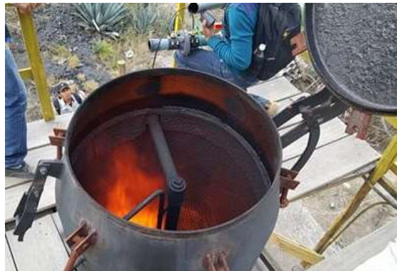
Figura 15. Calentamiento del gasificador Fuente: Propia
