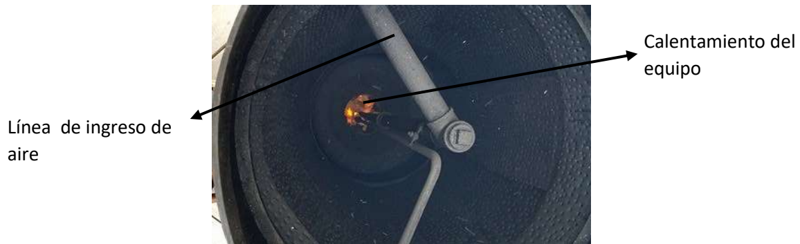
Figura 12. Encendido del gasificador. Fuente: Propia
