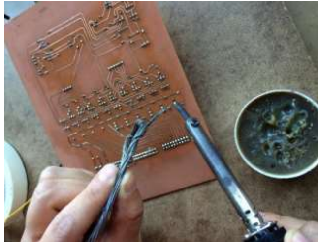
Figura 17. Soldadura de componentes
