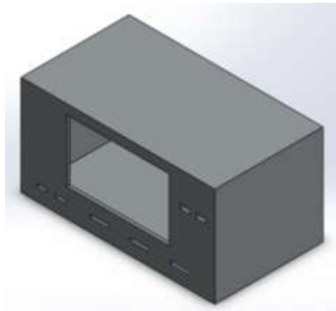
Figura 18. Diseño de la carcasa del comprobador
