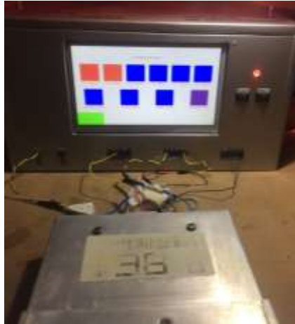
Figura 32. Prueba de funcionamiento con la ECU del Corsa B 1.6L.
