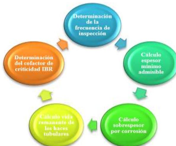
**Figura 14.** Proceso cálculo frecuencia de inspección
