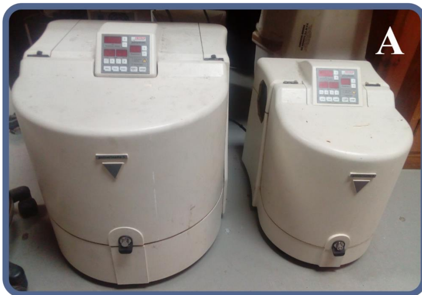
Figura 1. A. Molinos planetarios Fritsch Pulverisette 5 y 6 de alta energía. B. Molino planetario Fritsch modelo Pulverisette 6 con un tazón de 250 ml.
