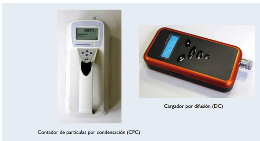
Figura 8.1. Ejemplos de equipos portátiles para medición de nanopartículas. Fuente: Seguridad y salud en el trabajo con nanomateriales - INNST (2015, p36).
