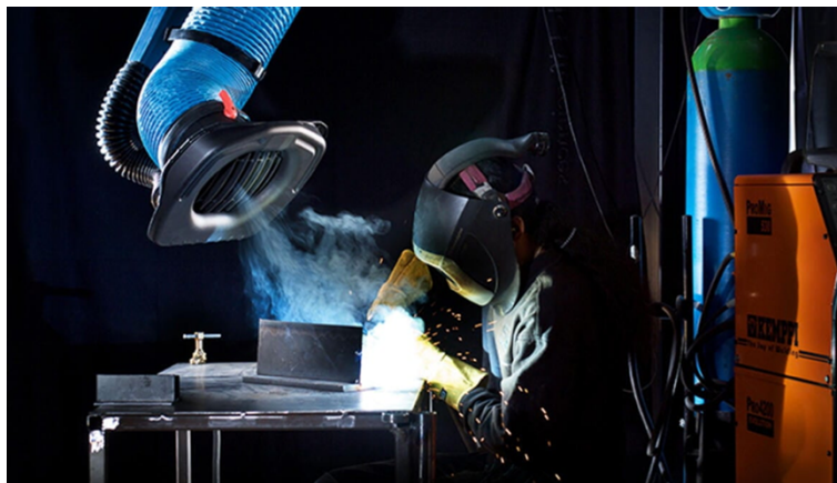
Figura 9.5. Campana de extracción de humos de soldadura. Fuente: NEDERMAN (2024).
