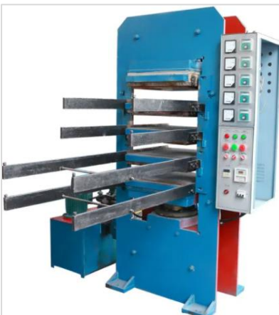
Figura 5. Máquina para baldosas de caucho
