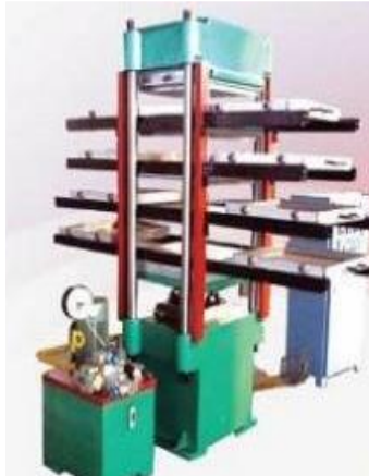
Figura 10. Prensa hidráulica a 180°C
