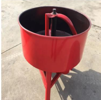
Figura 4. Mezcladora de polvo de neumatico
