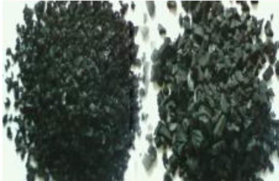
Figura 1. Forma granulométrica del polvo de neumático
