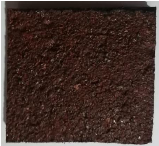
Figura 13. Probeta para dureza SHORE A
