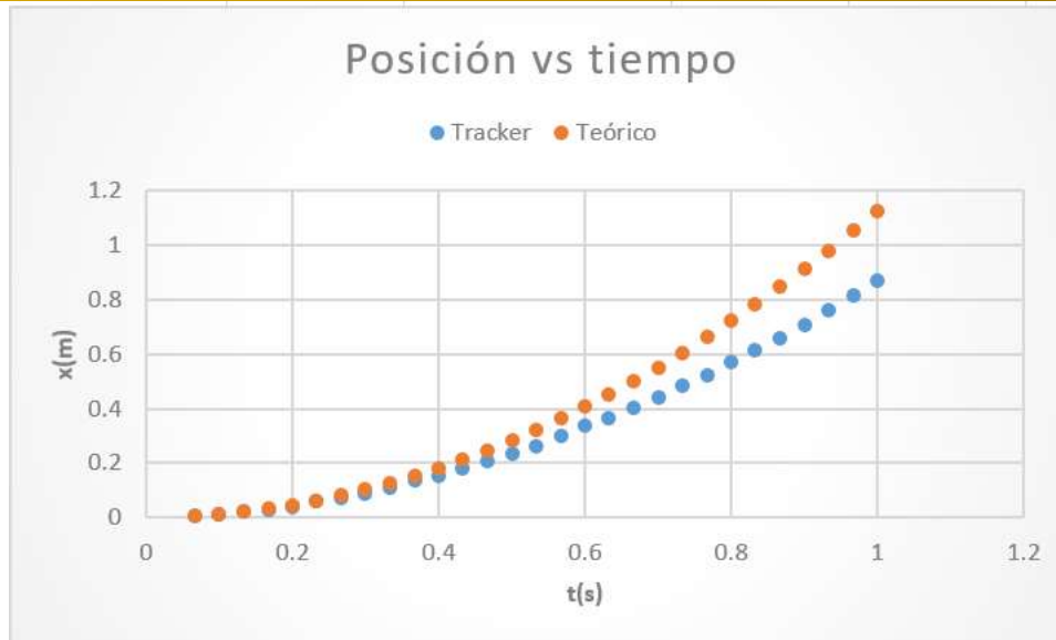
Figura 4. Posición del carro: compara valores experimentales con lo teórico. Con el flexómetro medimos la altura del riel (23 cm) y la distancia entre el extremo del riel en el suelo y el soporte (97 cm). El ángulo de inclinación es:
