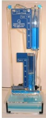
Figura 3. Sistema de tanques acoplados
