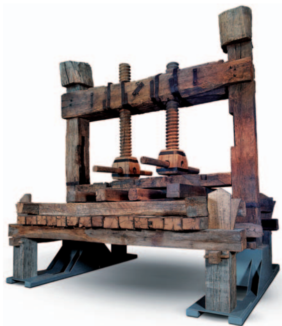
Fig. 2. Prensa vertical de puente con dos husillos de presión directa, procedente del palacio de los Torrecilla, en Badarán (La Rioja, España). Madera de nogal y de roble. Comienzos del siglo XVIII, con una reparación en el año 1829 (Museo de la Cultura del Vino – Dinastía Vivanco) (foto: CCV – DV / Adriana Landaluce).
