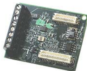
Figura 52 Placa sensora para Imote2
