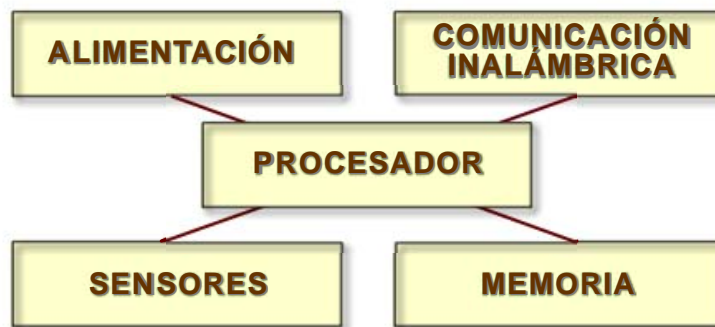
Figura 3 Arquitectura de un nodo inalámbrico
