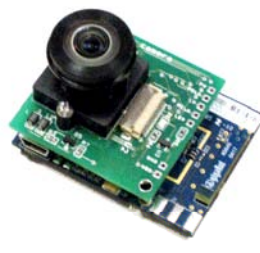
Figura 18 Imote2 con cámara integrada
