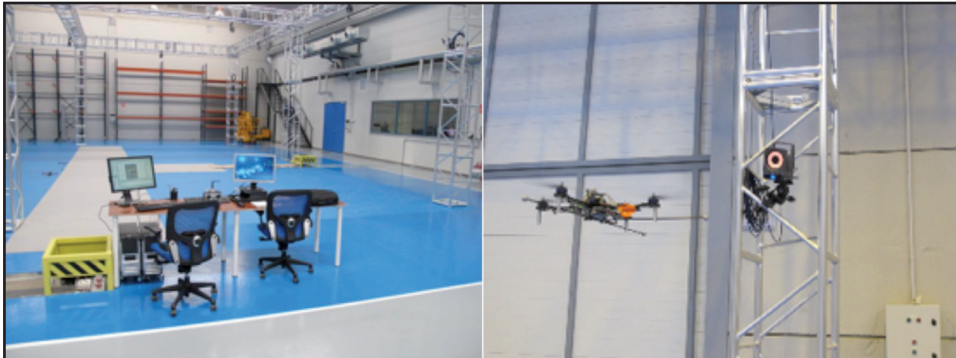
Figura 1. — Escenario indoor desarrollado por FADA CATEC en sus instalaciones de Sevilla. Navegación mediante cámaras fijas.
