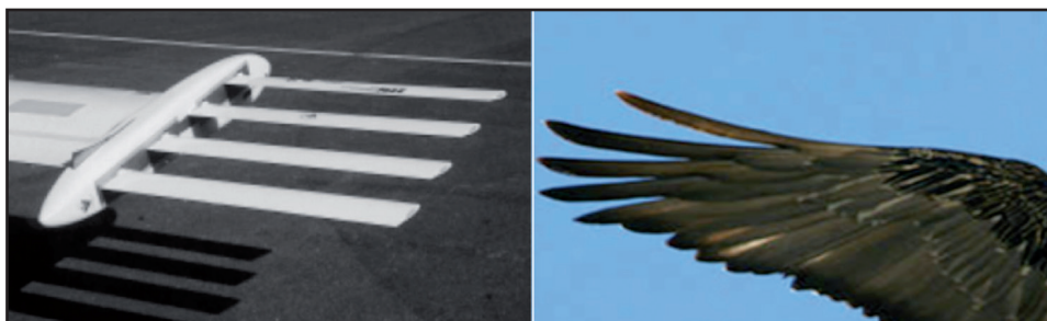
Figura 1.— Dispositivo de borde marginal Wing Grid y borde marginal de un ave en vuelo de planeo.
