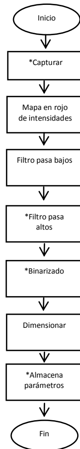
Figura 9.1 Secuencia para el procesamiento de imagen de algoritmo propuesto
