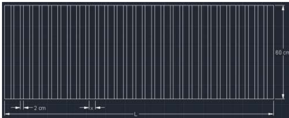
Figura 1.6 Dimensiones de las bocas de tormenta
