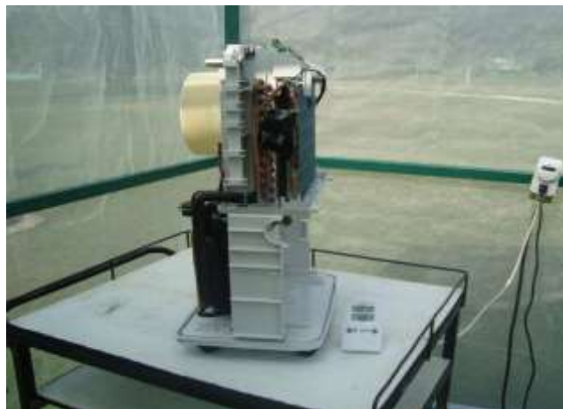
Figura 11.1 Modulo de generación de agua atmosférica
