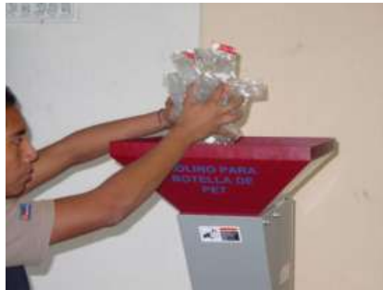
Figura 15.3 Trituración de PET
