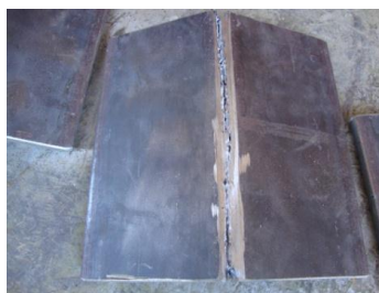
Figura 23.8 Probeta 4 (posición horizontal)
