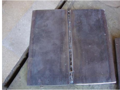
Figura 23.10 Probeta 2 (posición plana)
