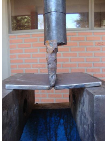
Figura 23.6 Rompimiento de las probetas
