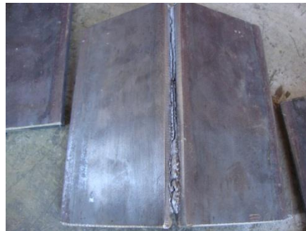
Figura 23.10 Probeta 2 (posición plana)
