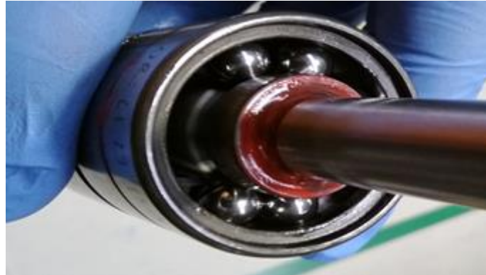
Figura 14.5 PokaYokede falta de jaula de rodillos
