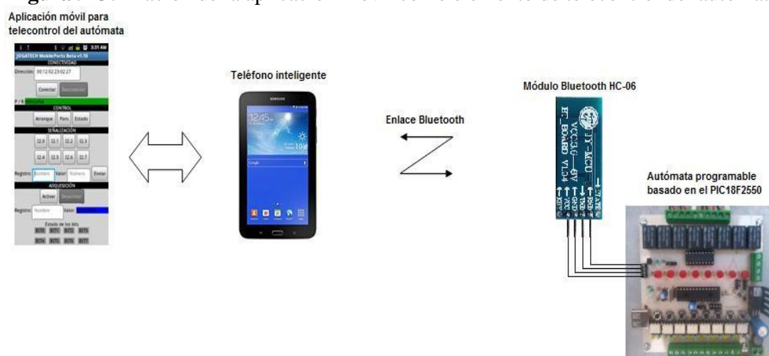
Figura 9 Utilización de la aplicación móvil como elemento de telecontrol del automata
