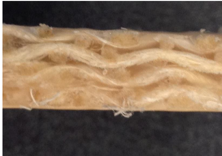
Figura 8.6 Fotografía de la sección del material obtenido por infusión
