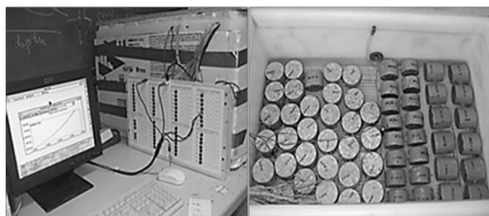
Figura 19.3 Especímenes de concreto reforzado evaluados en CAMS
