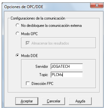
Figura 9.6 Cuadro de diálogo para configurar la conexión DDE en FESTO FluidSIM
