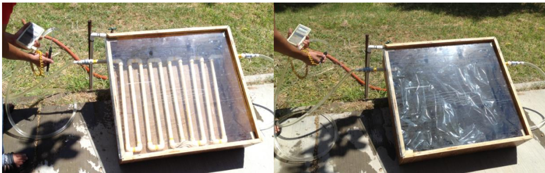
Figura 13.1 Medición de temperaturas en paneles CPVC y de cobre.
