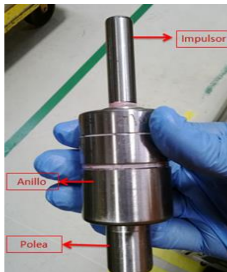
Figura 14.9 PokaYoke de diámetros exteriores bajo tolerancias
