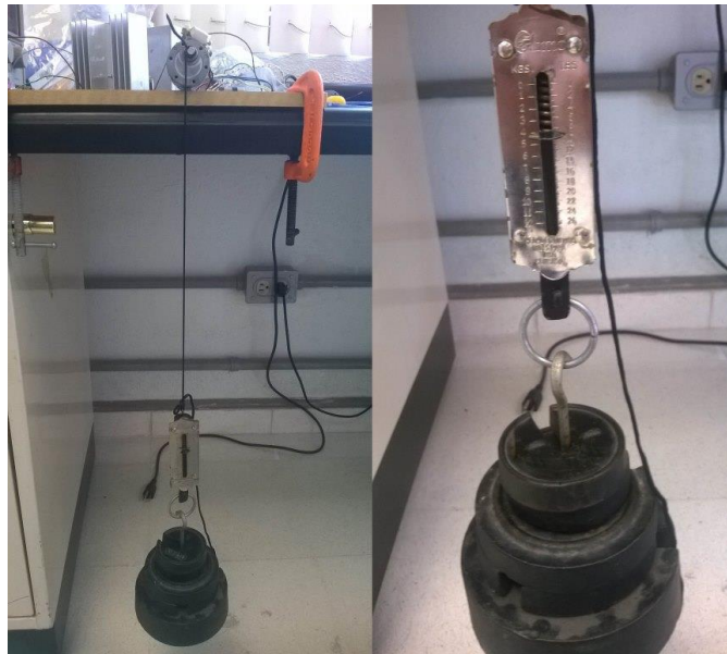
Figura 24.7 Carga colocada en el eje, colgando de un dinamómetro para su medición
