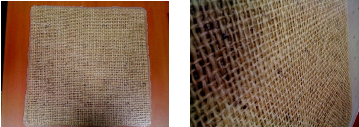
Figura 8.5 Placa de fibra de henequen obtenida por el método de infusión con 4 capas de tejido ortogonal y fibra poliéster.
