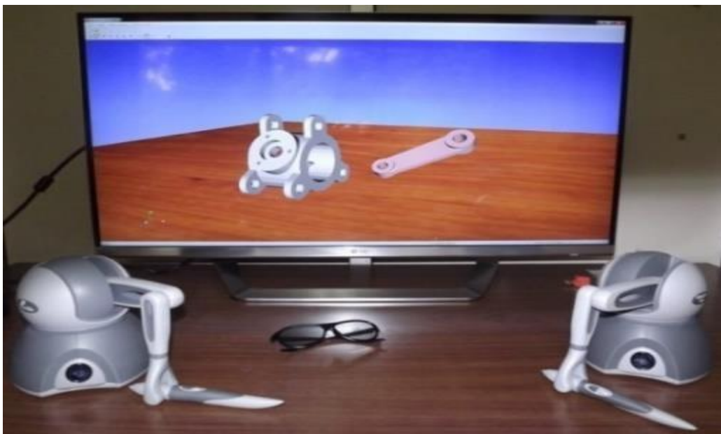
Figura 7.3 Interfaz háptica del sistema de ensamblajes virtuales HAMS
