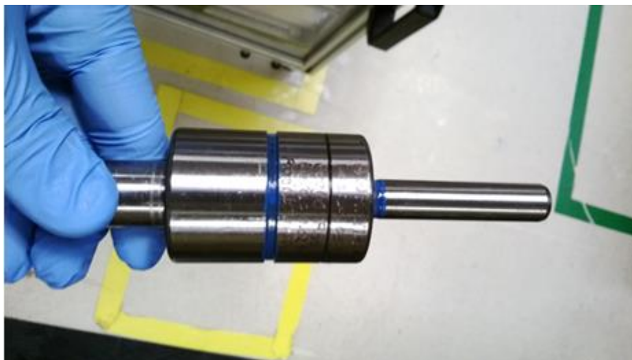
Figura 14 PokaYoke correspondiente al juego radial de pista de bolas y rodillos
