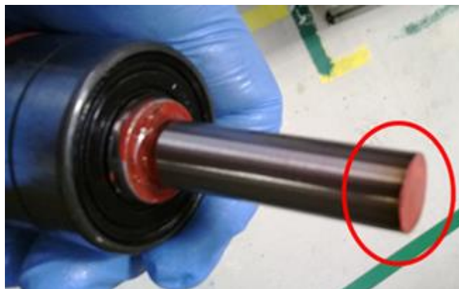
Figura 14.10 PokaYoke de longitud con desbaste en la cara del lado impulsor
