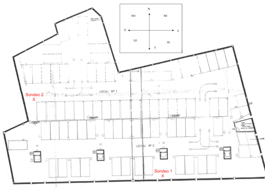
Figura 1. Plano de planta del sótano del edificio estudiado, con la posición de los sondeos realizados. La fachada principal es la situada en el extremo Sur.
