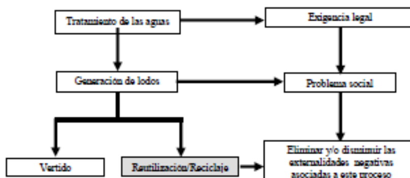
Gráfico 1: Gestión de los lodos obtenidos de un proceso de tratamiento de las aguas residuales
