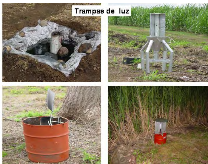
Figura 38. Diferentes tipos de trampas de luz para la captura de adultos de Gallina ciega
