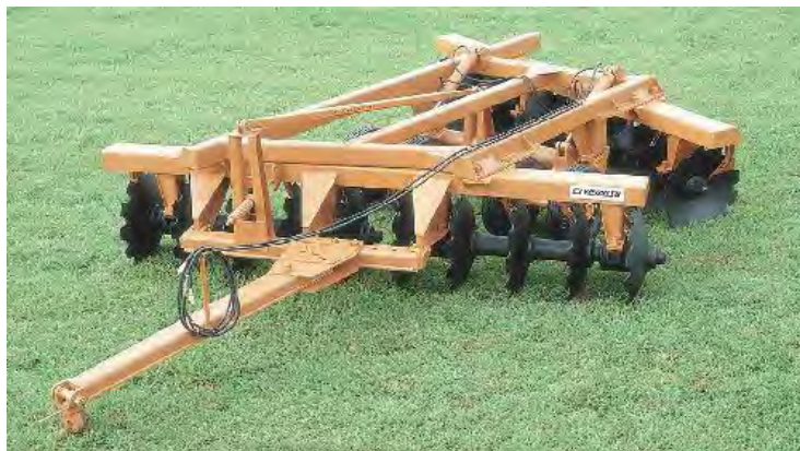
Figura 4. Rastro arado de 20 discos de 81 cm (32 pulgadas)
