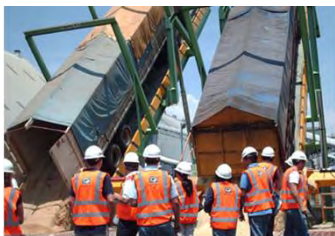
a) Descarga de unidad transporte azúcar crudo a granel.
