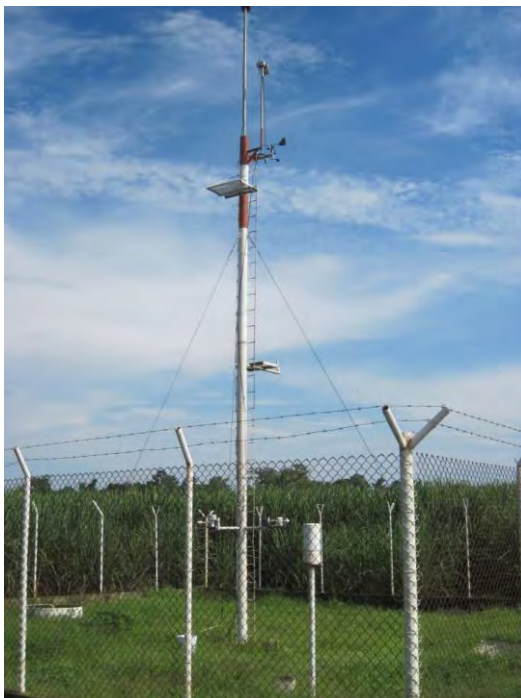
Figura 2. Estación meteorológica automática ubicada en ingenio Tululá
