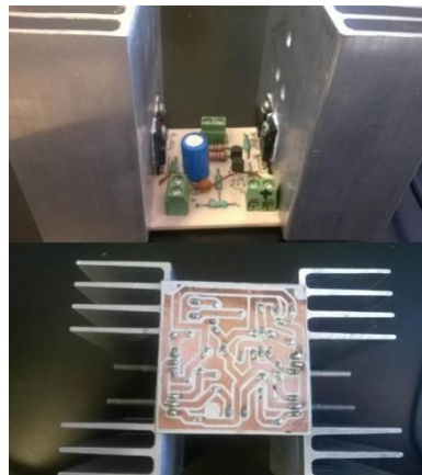
Figura 3.3 Vista superior e inferior del circuito del puente H con MOSFET
