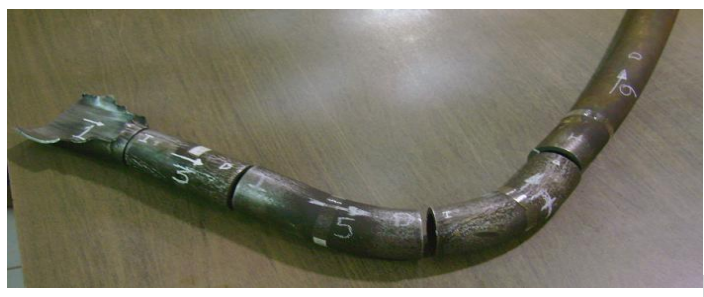
Figura 1 Cortes primarios realizados al tubo para su análisis
