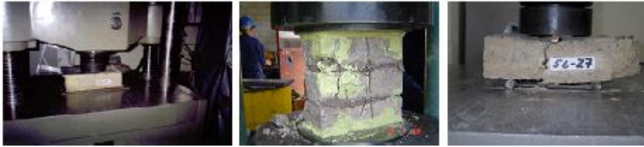
Figura 6: Caracterización mecánica. Compresión sobre adobes
