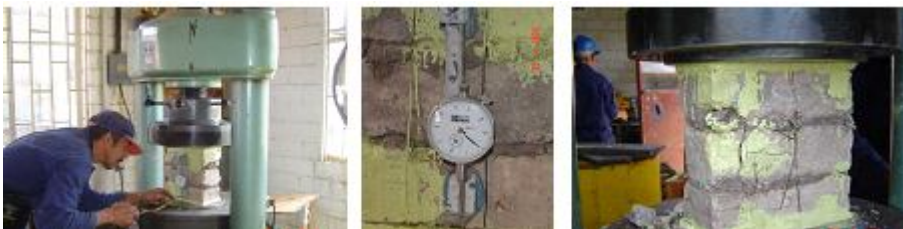
Figura 8: Caracterización mecánica en la ECI: Compresión sobre muretes de adobe
