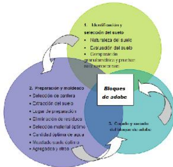
Figura 2. Diagrama del proceso de fabricación del adobe - Unidad básica del mampuesto
