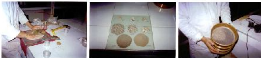
Figura 5: Capilla doctrinera de Tausa Vieja. Caracterización física de adobes y mortero de pega
