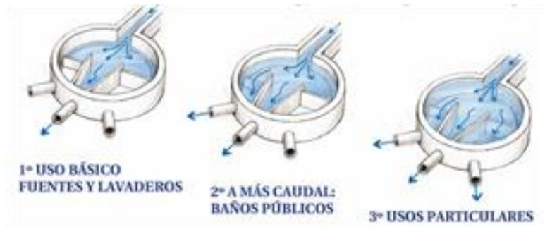
Figura 22. Funcionamiento de un partididor. Fuente: Feijoo, 2006
