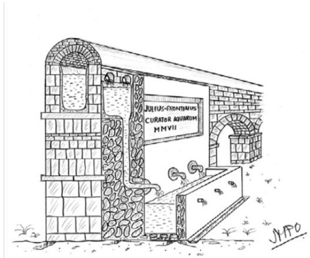
Figura 26. Fuente aliviadero típica romana. Fuente: De la Peña, 2010
