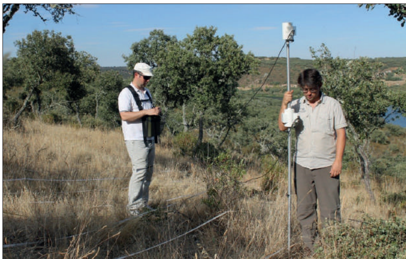
Fig. 57. Prospección mediante magnetometría realizada en El Castellón durante la campaña de 2014.
