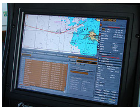
Figura 6. Sistema de navegación por satélite con carta náutica electrónica de un buque petrolero.
