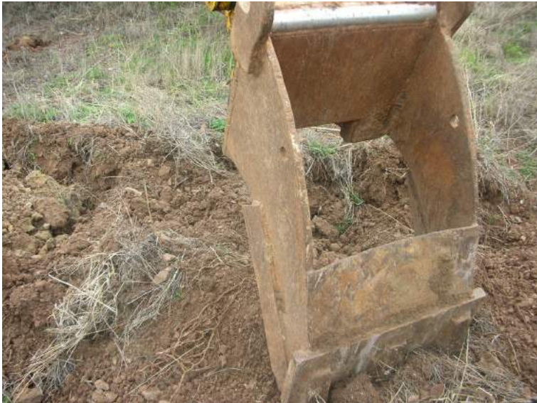
Imagen 2: Detalle de cazo abierto de la retroaraña con 90 centímetros de longitud.
