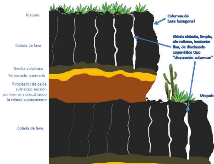
Figura 5. Esquema de la estructura de las laderas naturales de la isla de El Hierro.
