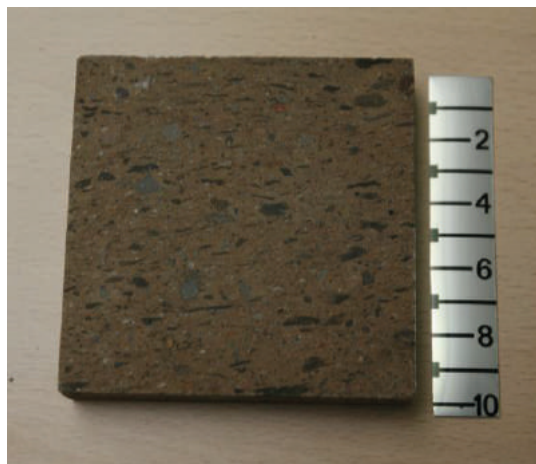
Figura 17. Muestra de mano de ignimbrita soldada (IGS).
