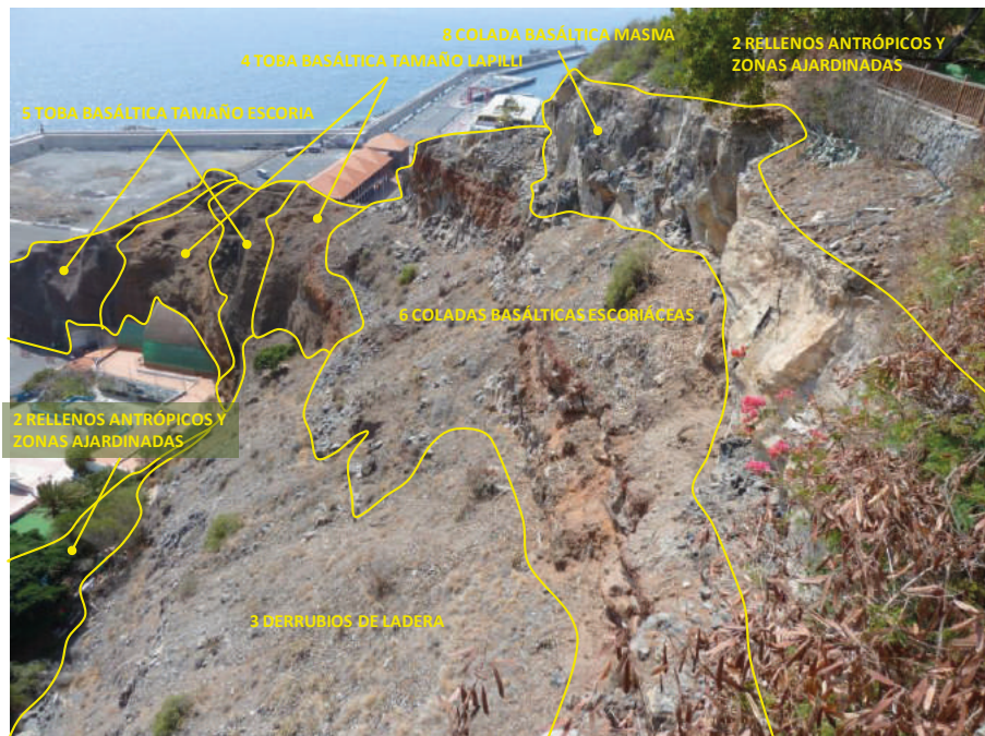
Figura 3. Distribución de los materiales en la ladera de estudio.
