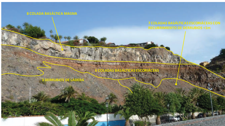
Figura 4. Distribución de las coladas basálticas y derrubios de ladera.
