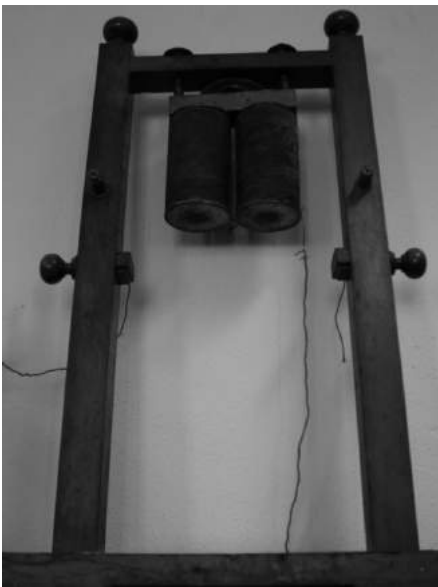
Fig. 8. Electroimán gigante de dos bobinas en forma de U, con ramas de 40 cm. y capacidad para levantar pesos de 100 kg montado sobre un cuadro de madera.
