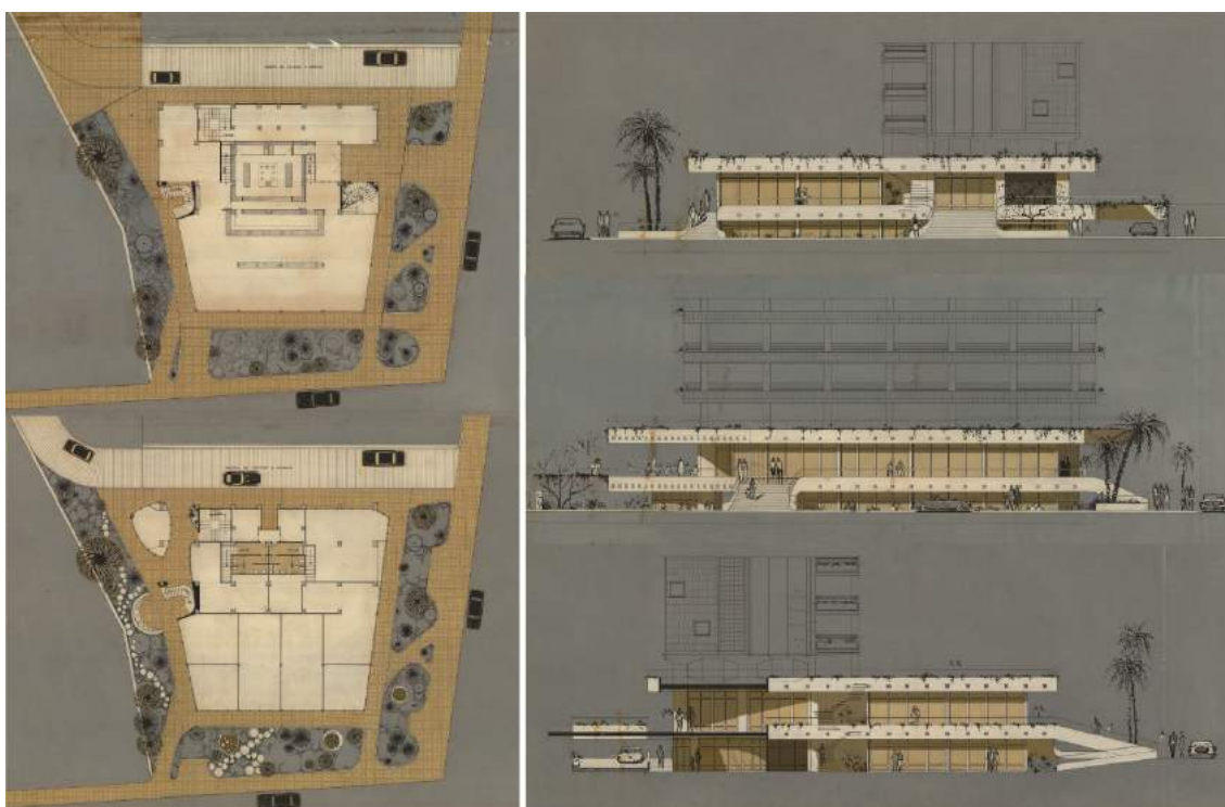
F06.- Plataforma comercial: plantas semisótano, baja y alzados (APJGG)
