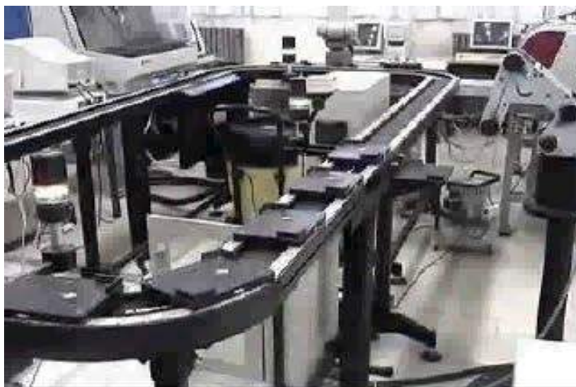
Figura 35. Cinta transportadora o CONVEYOR. Fuente: Elaboración propia.
