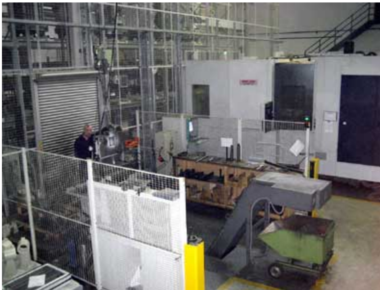
Figura 3. Célula de fabricación flexible para piezas de torneado (esquema e imagen). Fuente: Interempresas.
