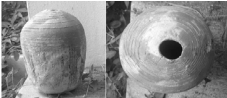
Fig. 5. Detalle de pieza aligerante. Dos vistas de la pieza de barro moldeado y texturizado utilizado en las bóvedas del Templo de San José. Colima. Fotografías del autor, 2015
