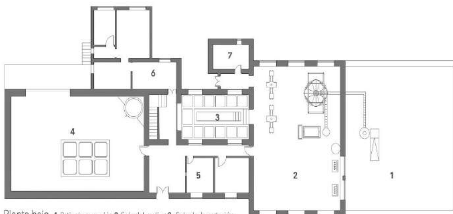
Planta baja_ 1. Patio de recepción 2. Sala del molino 3. Sala de decantación 4. Bodega 5. Administración 6. Vivienda 7. Aseos
