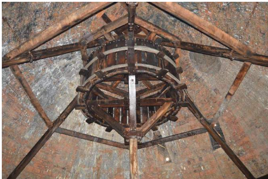
Figura 5. Baritel de san Andrés en el Parque Minero de Almadén (Ciudad Real, España. Fuente: Alfonso Fernández-Arroyo (2016)
