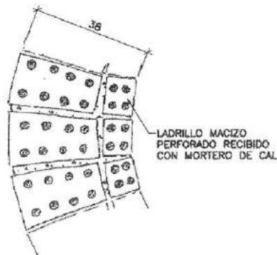
Figura 6.c.. Detalle del muro de la chimenea de ladrillo
