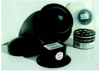
**Figura 2.** DTPA (detector de partículas alfa) y lector DTPA.
