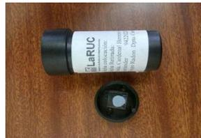
**Figura 3.** DTPA tipo LaRUC (dispositivo en tapa).
