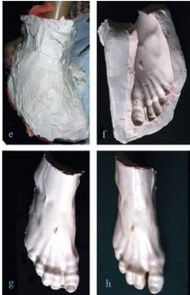
Figura 3. e) contramolde de yeso; f) molde extraído; g) vaciado positivo del pie en yeso duro; h) aplicación de resina para realizar la lámina transparente sobre el vaciado positivo del pie. Francisco Javier Casaseca García, 2014. Iglesia parroquial de San Vicente Mártir de Zamora
