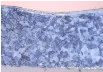
Figura 6.- Microestructura acero inoxidable grado UNE EN1.4512 100x ataque vilella.
