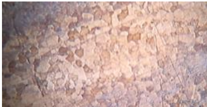
Figura 12.- Material base de soldadura láser 100X, ataque vilella
