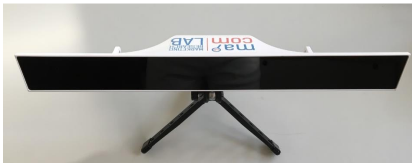
Figura 1. Barra de seguimiento ocular. Marca Gaze Point. Fuente: elaboración propia.
