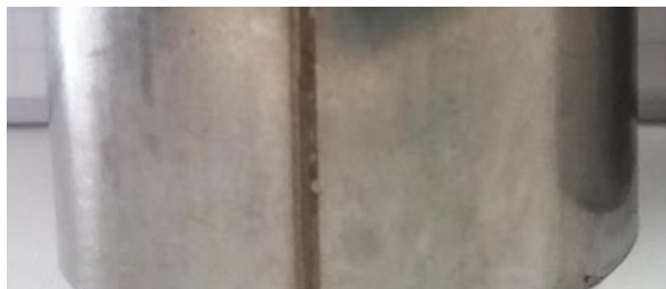
Figura 10.- Tubo soldado mediante proceso láser
