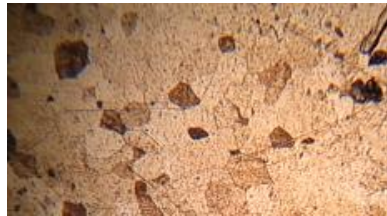
Figura 13.- Material base de soldadura HF 100X, ataque vilella
