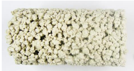
Figura 1. Material poroso de matriz cementicia aligerado con vermiculita obtenido en laboratorio
