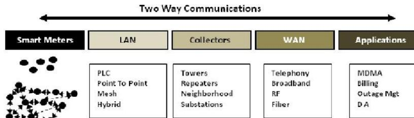
Figura 12. Arquitectura básica de los contadores inteligentes. Source: Reference [1]
