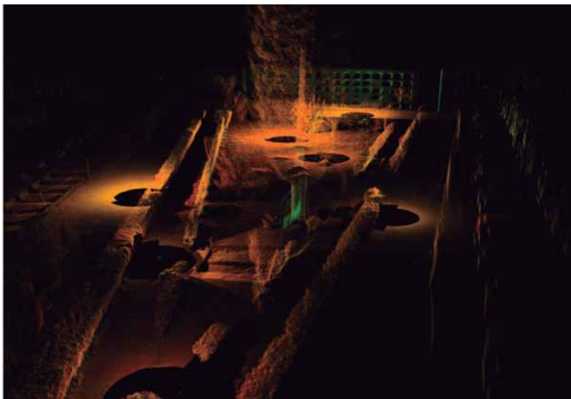
Imágenes con nube de puntos del área ajardinada del Pico Reja durante la intervención arqueológica, a partir de escáner láser.
