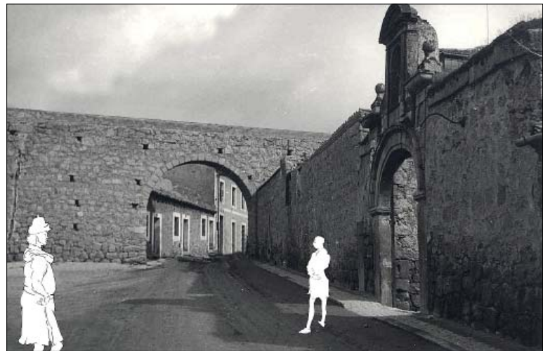
Reconstrucción del conocido Arco de la Luna con la conducción cerámica en su parte superior (oculta a la vista con un pretil). (Del vídeo realizado por el MAV & el GI de Paisaje Cultural E.T.S.A. UPM).
