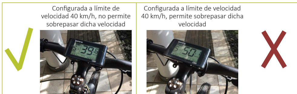
Figura 17. Límite de velocidad erróneo (Código LME).
