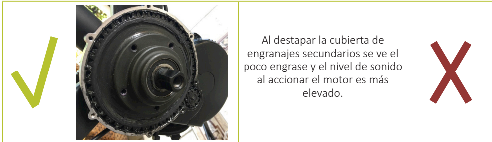
Figura 10. Engrase insuficiente (Código EI).
