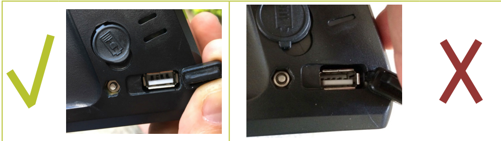
Figura 12. Puerto USB desalineado (Código PUD).
