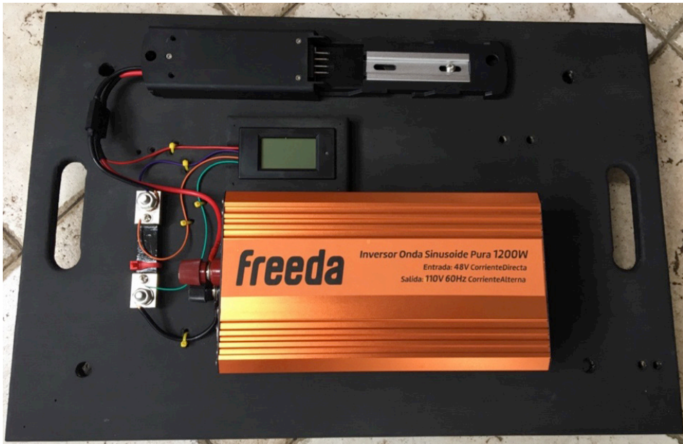
Figura 19. Descargador de baterías.
