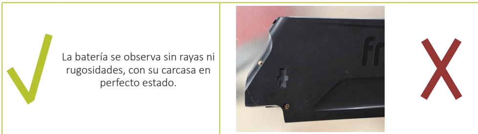
Figura 13. Batería rayada (Código BR).
