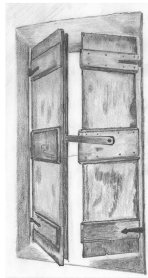
Fig. 13. Elementos de una ventana. (dibujo de Pilar Munné)
