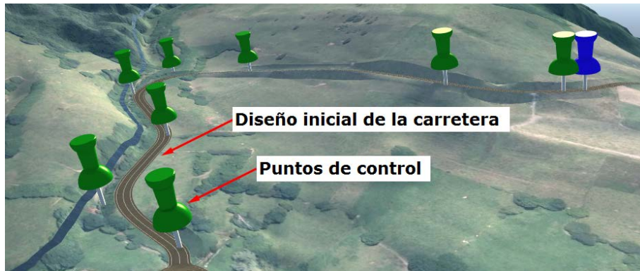
Figura 4. Diseño inicial de la carretera a partir de puntos de control proporcionados al Alumno.
