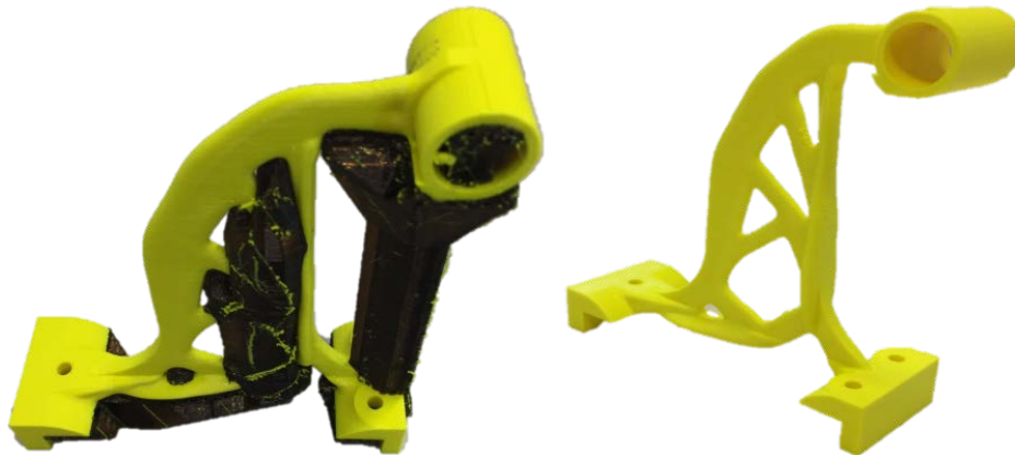
Figura 3. Ejemplo de un prototipo de Diseño Generativo fabricado a través de la impresora 3D Dimension Elite de Stratasys , basado en la tecnología FDM ( Fused Deposition Modeling ).
