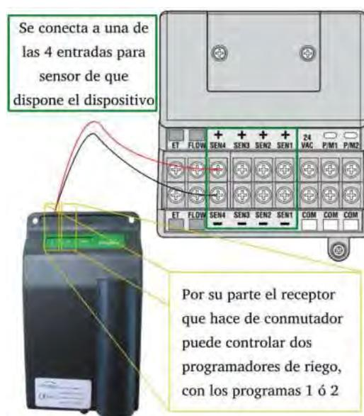
**Figura 4. Esquema de conexión del conmutador inalámbrico a los programadores antiguos de riego.**
