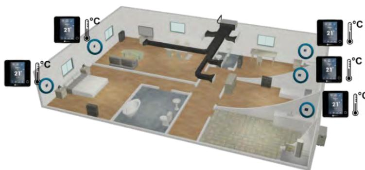
Figura 1. Esquema de un sistema zonificado.
