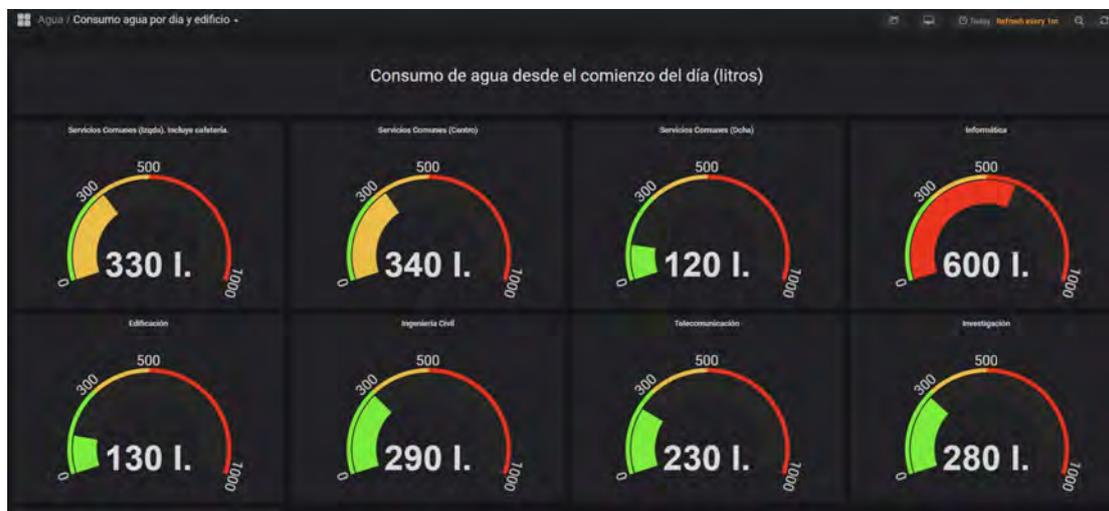
**Figura 1: Sistema de visualización de datos de consumo de agua (en litros) por día en los diferentes edificios de la EPCC**
