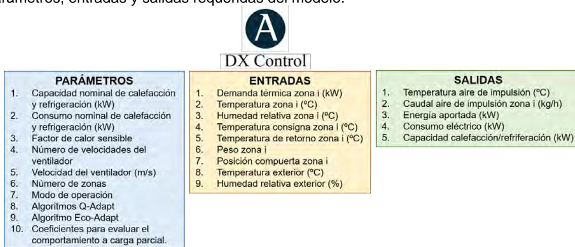
Figura 6. Parámetros, entradas y salidas del modelo de control.
