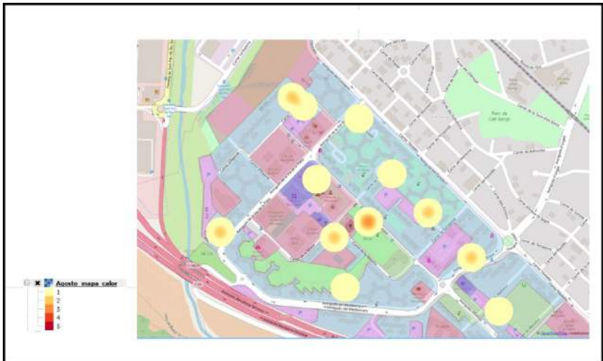
Figura 1. Mapa de calor requerimientos ruidos con representación de puntos calientes densidad Kernel mes de agosto de 2015. Fuente: Elaboración propia a partir de SIG Qgis y OpenStreetMap.
