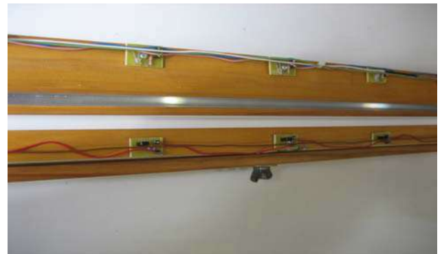
Figura 6. Distribución de diodos y fotodiodos a lo largo del plano inclinado
