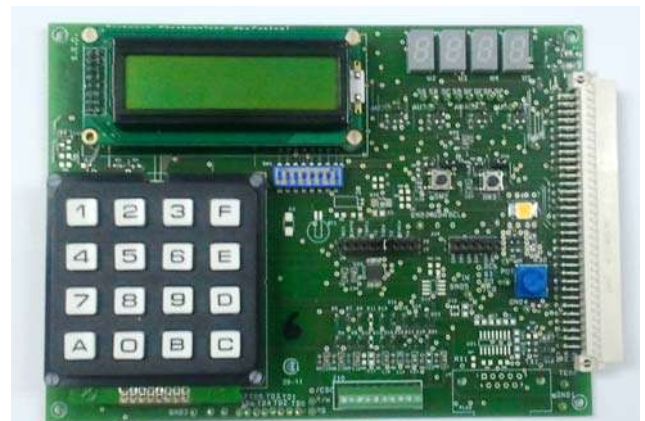
Figura 5. Aspecto de la tarjeta de periféricos desarrollada
