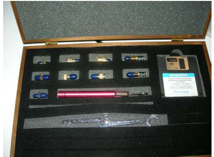
Figura 2. Kit de calibración del analizador vectorial de redes para conectorización SMA.
