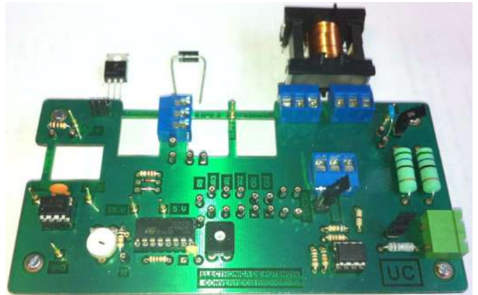
Figura 5. Placa de trabajo. En la parte superior se muestran el MOSFET, diodo e inductancia con los que trabaja el alumno.
