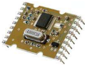
Figura 1. Imagen del módulo de Radio-Frecuencia utilizado para el desarrollo de la aplicación, FM-RXQ1-433RF.
