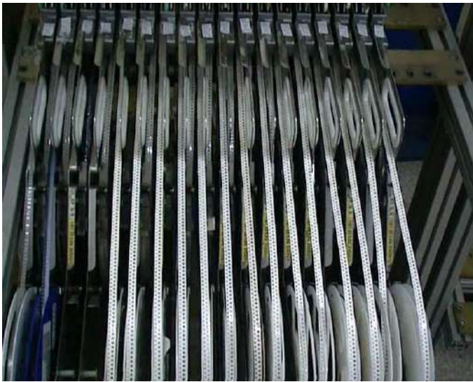
Figura 3. Componentes dispuestos en un alimentador para máquina de “pick & place”.
