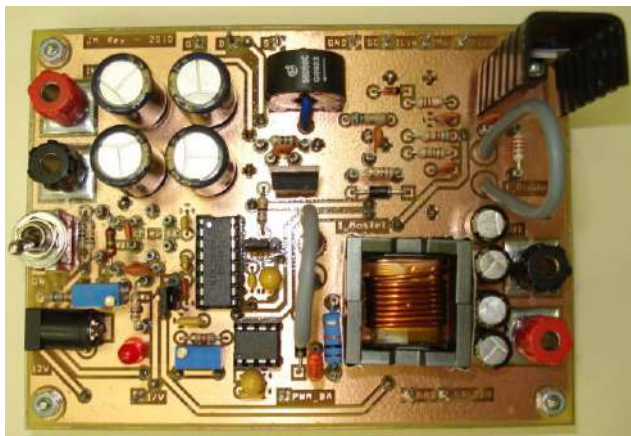
Figura 18 Módulo flyback orientado a la docencia
