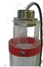
Figura 2. Vista en detalle de la parte superior del cilindro de metacrilato donde se encuentra ubicado el sensor sónico.
