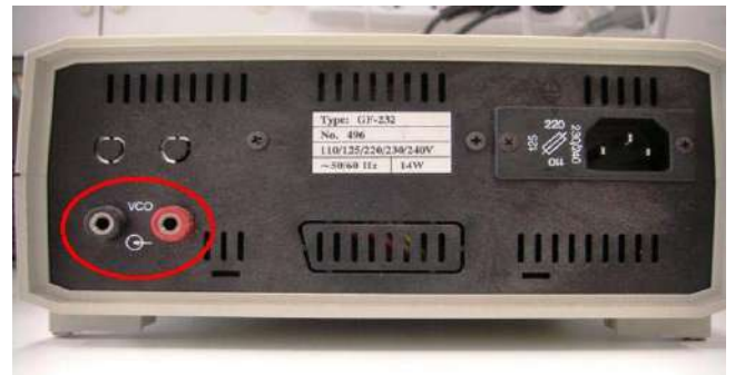
Figura 5. Entrada de control del VCO
