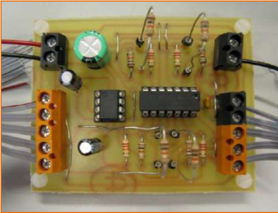
Figura 7. Circuito de Acondicionamiento de la Señal
