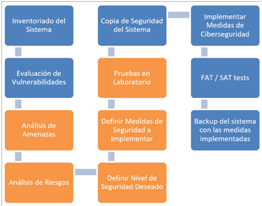
Figura 7. Flujo de trabajo de implementación de medidas de seguridad en un proyecto existente.
