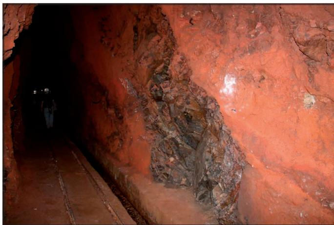
Figura 12; Dique en la traza de una galería.
