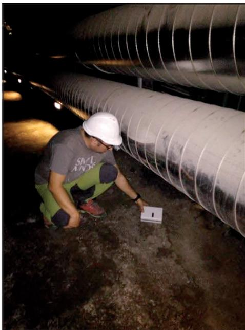
Figura 19; Instalación de detectores activos de gas radón.
