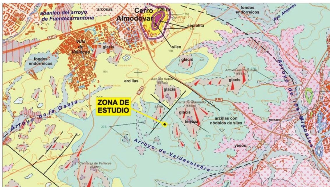
Figura 1. Mapa geológico general de la zona SE del municipio de Madrid, localizando la zona de estudio dentro de la zona de interfluvio o plataforma erosivo-estructural existente entre El Cañaveral y el Ensanche de Vallecas. Base cartográfica tomada del navegador espacial del IGME, constituido por la cartografía geológica continua 1:50.000 (GEODE).
