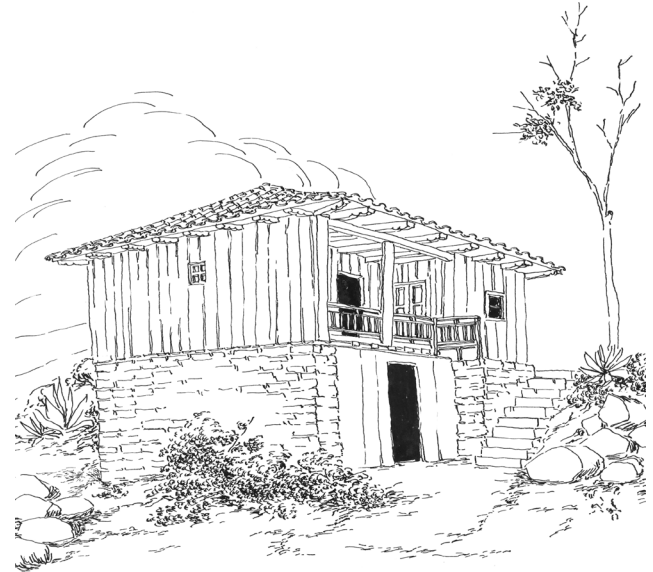
Imagen 28. Edificación en dos plantas con muros mixtos.
