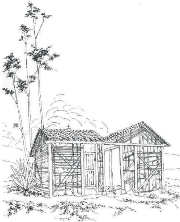
Imagen 25. Estructura para conformar muros de bahareque.
