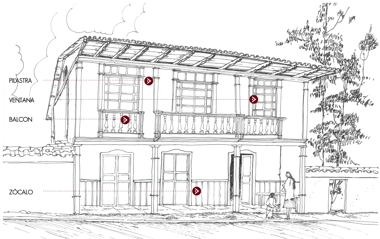
Imagen 51. Edificación con zócalos de madera.
