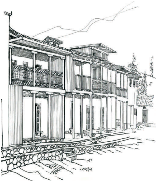
Imagen 40. Edificación con alero sin canecillo a la vista.
