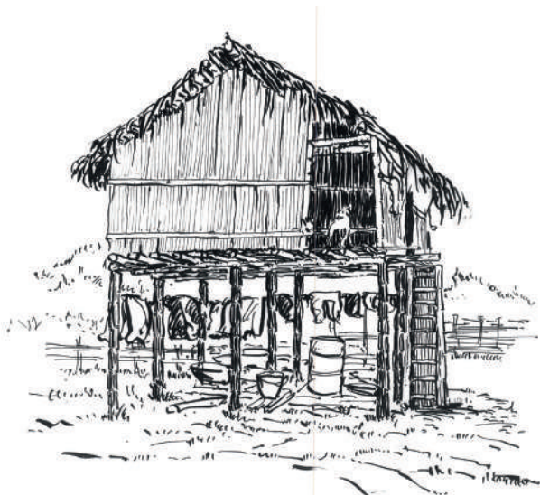
Imagen 04. Edificación con sistema constructivo de caña.
