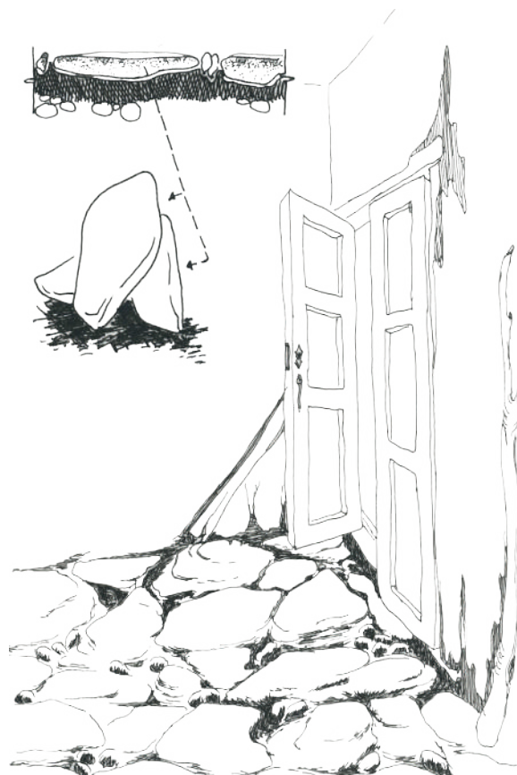
Imagen 44. Piso de recubrimiento de piedra.
