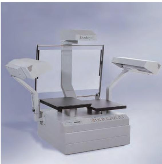
Dicho escáner Bookeye se utilizó en combinación con su software de digitalización **BCS-2**, constituyendo una solución de escaneado de libros de alto rendimiento que ha demostrado su fiabilidad.
