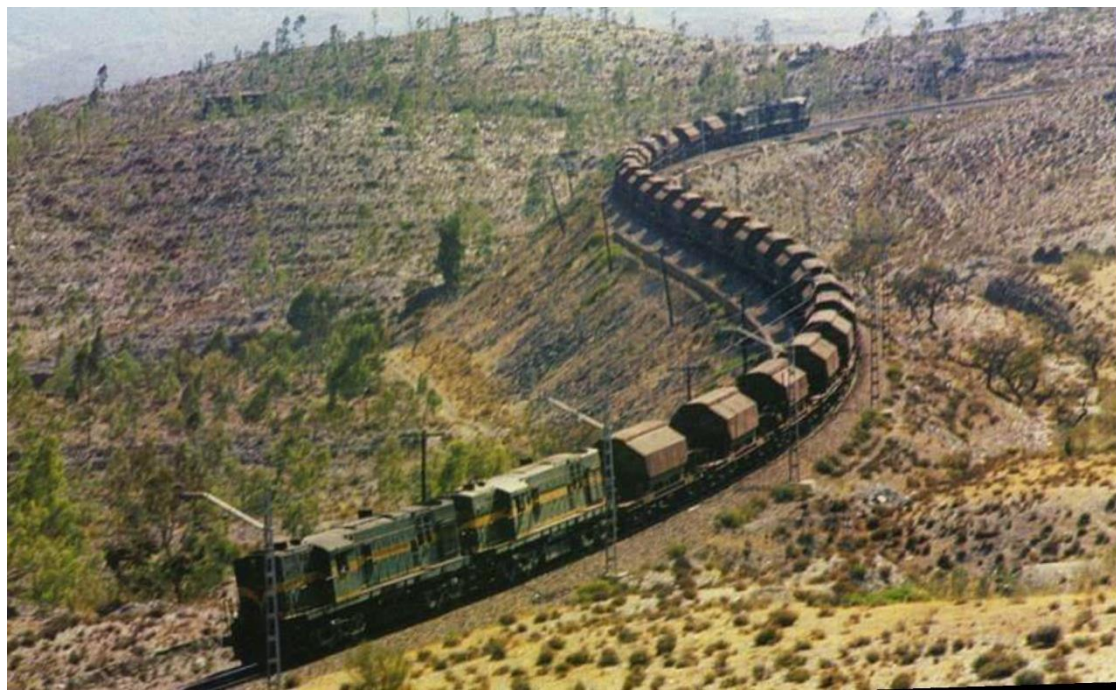
Figura 16. Tren de mercancías para el transporte de mineral entre Teruel y Valencia con dos máquinas en cabeza y dos en cola.
