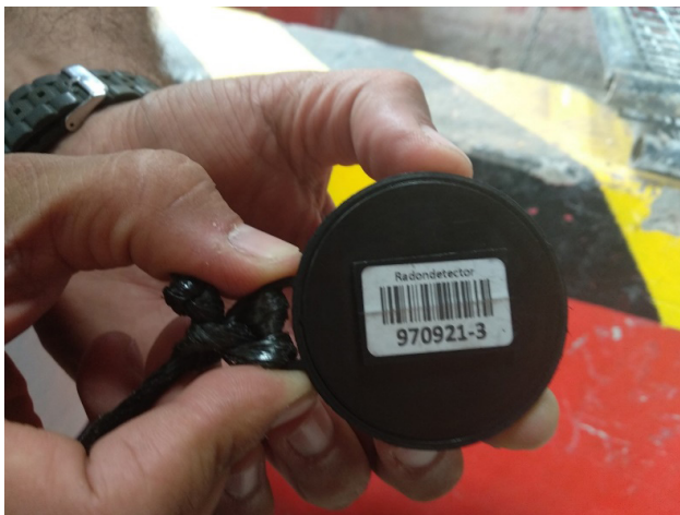
Figura 18. Colocación del detector pasivo de gas radón.
