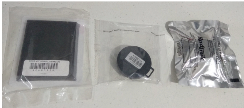
Figura 17. Detectores pasivos de radón en el momento del suministro
