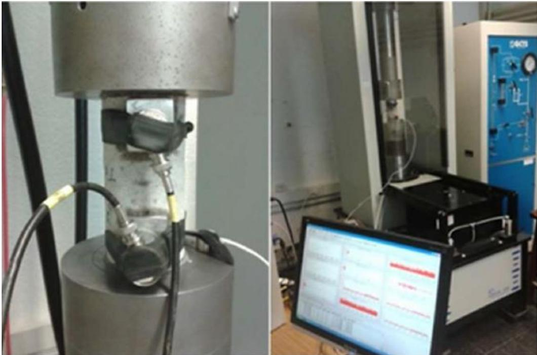
Figura 1 Configuración experimental y equipo de EA.
