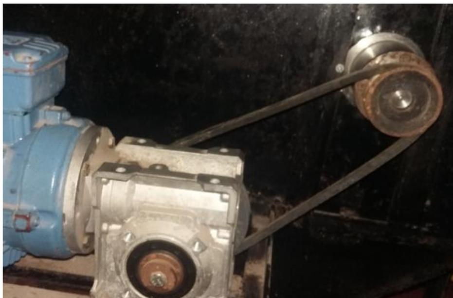
Fig. 3. Trasmisión de máquina de abrasión.
