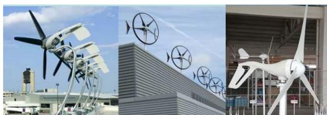
Fig. 9. a y b: Turbina eje Horizontal de 5 aspas, (a) orientación limitada, (b) orientable – c: turbina de tres aspas [4].
