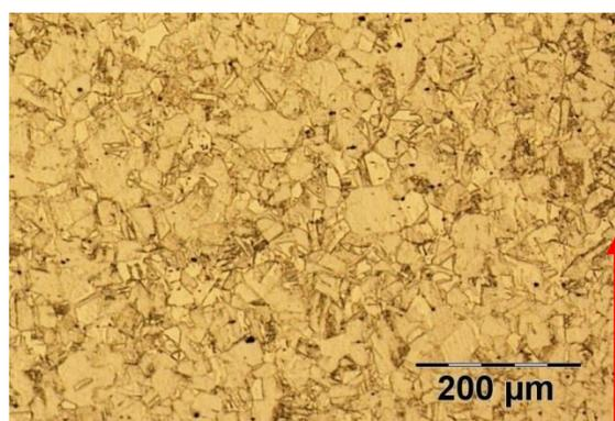
Figura 3. Fotografía de la microscopía óptica de la probeta sin deformación. La flecha roja indica el sentido de laminación.
