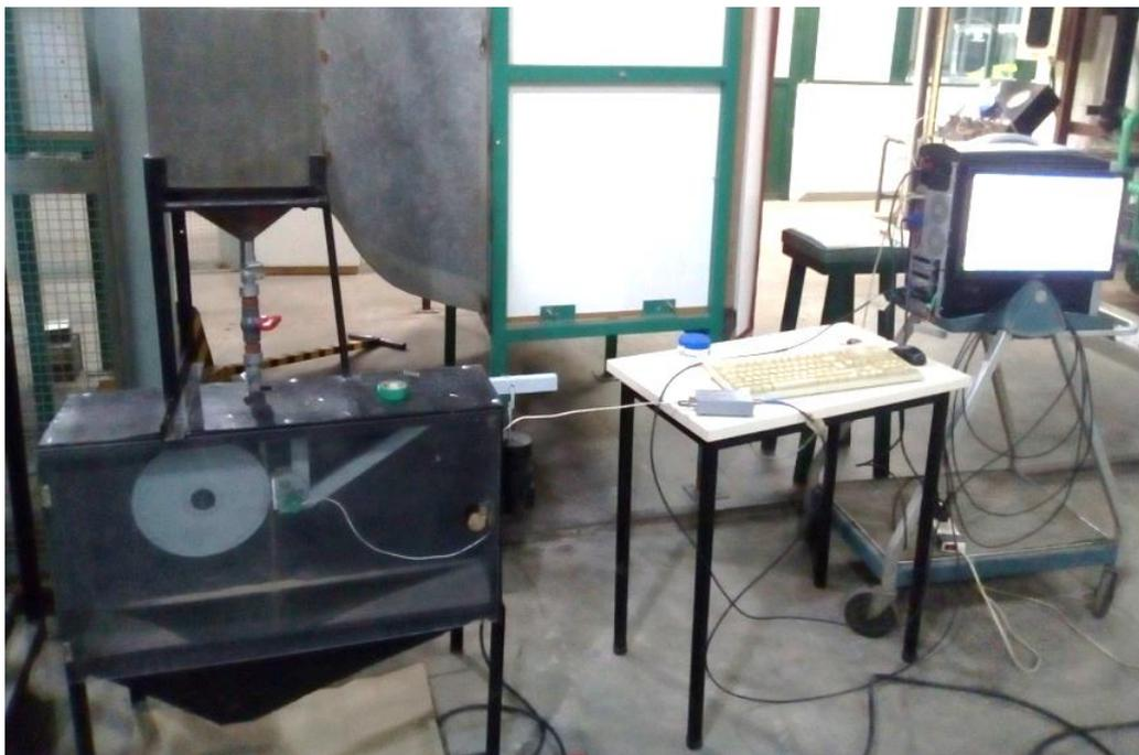
Fig. 4. Máquina G65 instrumentada con equipo de EA.
